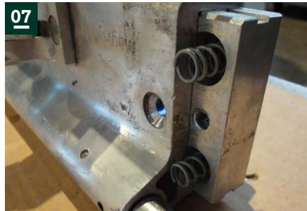
**07:** Neuen Fußblock in Führung einsetzen
