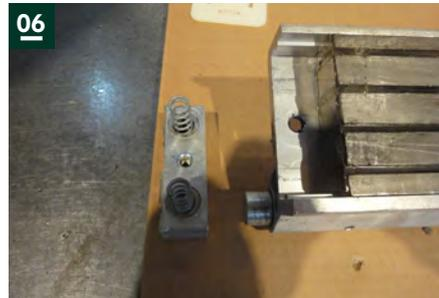
**06:** Demontierter defekter Fußblock
