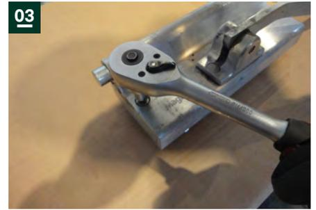
**03:** Befestigungsschraube lösen & entfernen
