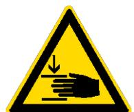
Bei der Bedienung des Exzenterhebels müssen Sie immer aufmerksam und sorgsam sein. Durch plötzliches Anziehen des Magneten kann der Exzenterhebel ruckartig in Bewegung geraten. Es besteht dabei die Gefahr von Quetschungen.
